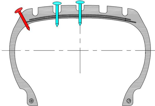
Ein Reifen wurde durch drei Nageleinstiche verletzt, die Leckstellen durch Fahren auf dem Prüfstand abgedichtet und das Ergebnis durch eine Druckprobe verifiziert. Nach der Druckprobe erfolgte ein Belastungs-/Geschwindigkeitstest nach ECE-Regelung Nr. 30 Absatz 6.2. mit positivem Prüferfolg.
